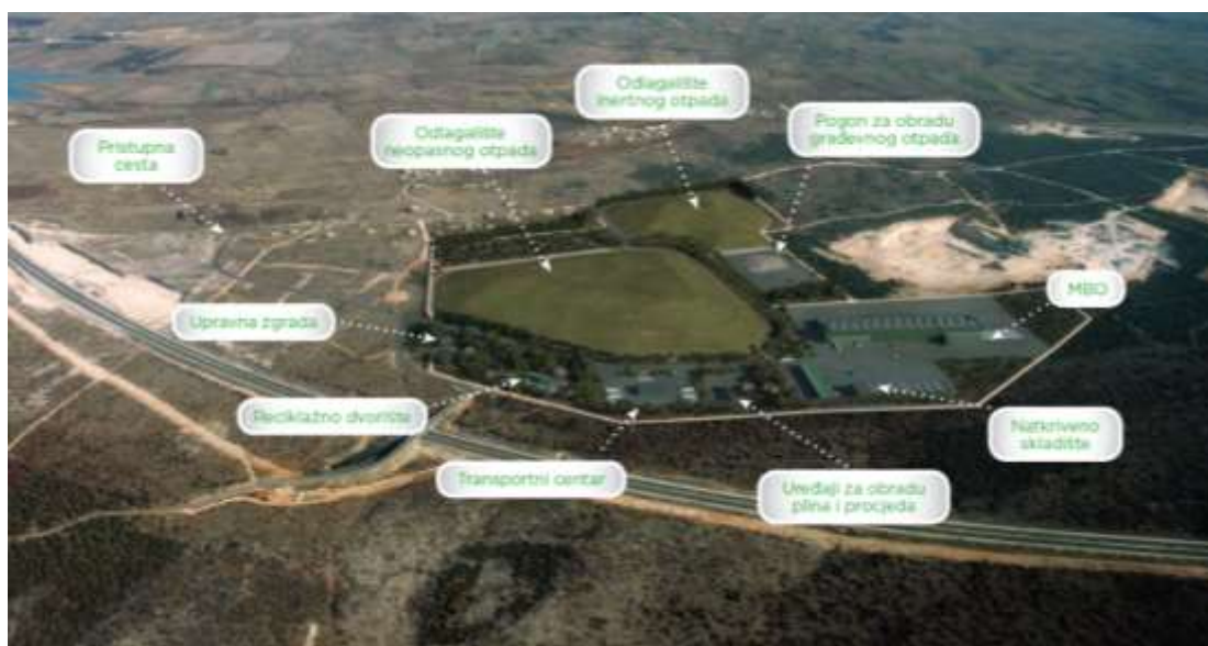
Slika 12.5. Centar za gospodarenje otpadom Biljane Donje – prikaz planiranih sadržaja Izvor: Eko d.o.o. Zadar, 2020.
